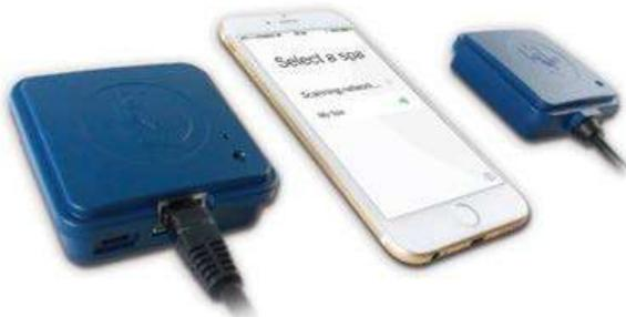
Jedes Modul in.touch2 verfügt über eine Status-LED, die zur Fehlerbehebung verwendet werden kann. Die LED befindet sich auf den Oberseiten beider Gehäuse.
