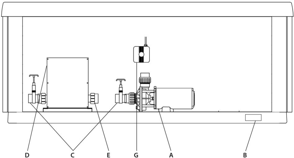
**A. Pumpen (eine oder mehrere, abhängig vom Modell):** Geringe Drehzahl für effiziente Wasserzirkulation während der Filterung und Erwärmung; hohe Drehzahl für maximale Leistung der Düsen. Die Pumpenfunktionen werden mithilfe der oberen Regler aktiviert.
